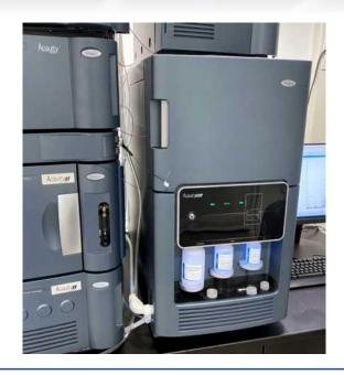
Die <u>BioAccord</u> ist ein Ready-to-Use LC-MS-System, das biopharmazeutische Analysen im Hochleistungsbereich benutzerfreundlich und als Komplettlösung ermöglicht. Selbstkalibrierend, selbstoptimierend, bioinert und mit intelligenter Software ausgestattet, ist das System konzipiert und optimiert für den Routineeinsatz, für die Qualitätskontrolle und unterstützt zugleich das wissenschaftliche Arbeiten.
